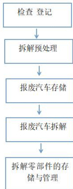
图2-1报废汽车拆解工艺流程图
